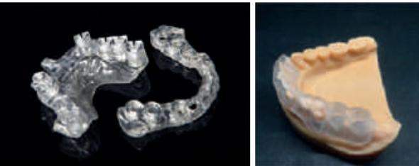
Im R2-Gate Zentrum werden nun die Bohrschablonen konstruiert und zum Produktionslabor geschickt. Dort wird die virtuelle Schablone mit einem 3D Drucker ausgedruckt.
