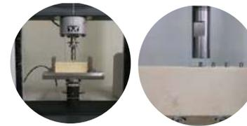
Instron-System zum Einsatz. Die durchschnittliche Belastung lag bei 220 N (22,4 kgf); wenn also das neue provisorische Abutment unter dieser Last bricht, kann es das Implantat vor Auslenkung oder Beschädigung schützen.
