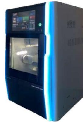
Die Megagen BX5 Fräs-/schleifmaschine verfügt über eine 5-Achs Simultantechnologie, welches es erlaubt auch komplexe Restaurationen mühelos herzustellen.
