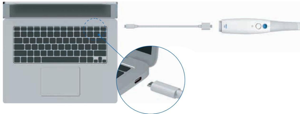
C Typ Anschluss + Stromversorgungskabel
